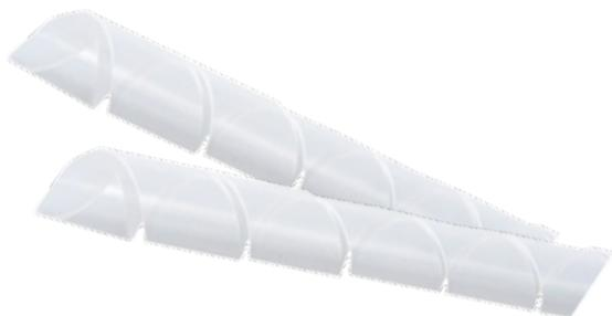
Лента спиральная монтажная SWB (spiral wrapping band) применяется для объединения кабелей в трассы, вязки в жгуты и разводки проводов, защиты кабелей от трения и механических повреждений. Лента производится из полиэтилена высокого давления с добавлением компонентов, препятствующих горению. Поставляется рулонами по 10 м.
