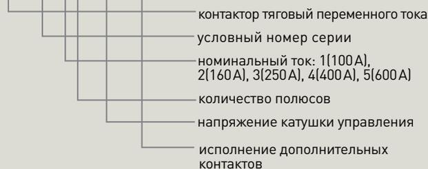
Контакторы электромагнитные серии КТ-6000 предназначены для включения и отключения приемников электрической энергии с номинальным напряжением до 660 В переменного тока частотой 50 Гц.
