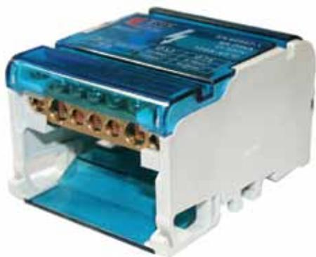
Нулевые шины в корпусе (кросс-модули) используются для подключения одножильных проводников либо многожильных, оконцованных наконечниками НШВИ. Изготавливаются с двумя или четырьмя шинами. Снабжены изолирующей задней панелью и прозрачной изолирующей передней крышкой.
