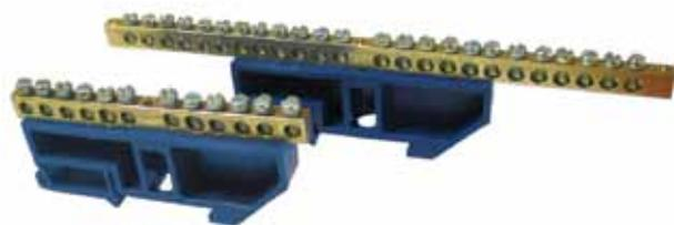
Шины предназначены для присоединения нулевых проводников (шина «N») и заземления (шина «PE»). Шины выполнены из латуни и никелированной латуни. Нулевая шина устанавливается на изоляторе.
