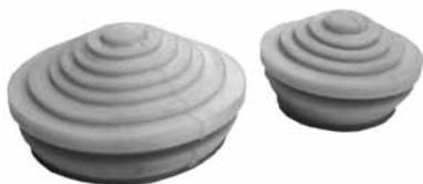
Кабельные вводы (сальники) служат для ввода проводов и кабелей в распределительные щиты и защиты от проникновения внутрь пыли и влаги.
