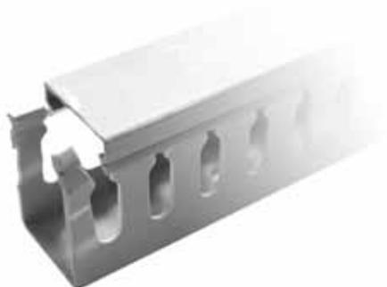
Используются внутри шкафов для формирования внутренних кабельных трасс. Наличие перфорации позволяет осуществлять легкий подвод кабелей к оборудованию, обеспечивает естественную вентиляцию и простое обслуживание сформированной трассы.
