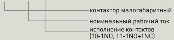
Контакторы электромагнитные серии КМЭ представляют собою коммутационные аппараты и предназначаются для дистанционного пуска, остановки и реверсирования трехфазных асинхронных электродвигателей с короткозамкнутым ротором в сети переменного тока частотой 50/60 Гц с напряжением до 660 В (категория применения АС-3) и для дистанционного управления электрическими цепями в которых ток включения равен номинальному току нагрузки (категории применения АС-1).
